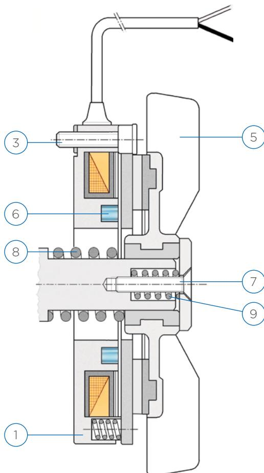
Montar el muelle de empuje (8) en el árbol y la chaveta. Montar el cuerpo freno (1) en la brida motor con los tornillos de fijación (3), asegurándose de la planicidad de la brida motor y la orthogonalidad del plano de la misma con respecto al eje de rotación del árbol.
